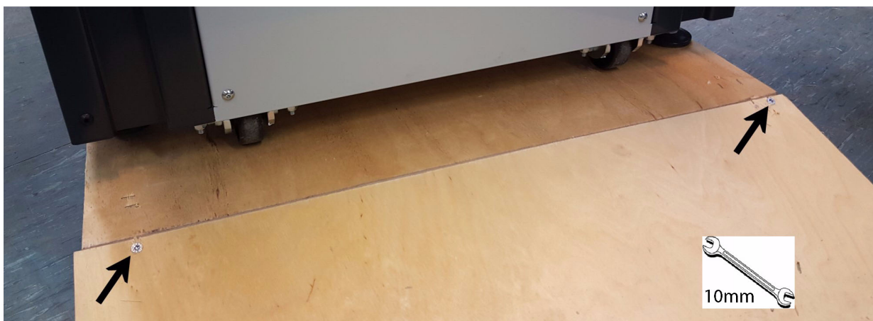
Рис. 5-6: Крепление крышки к поддону двумя шурупами.
