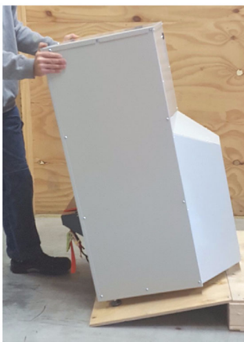
Рис. 5-11: Для спуска машины по скату слегка наклоните её.
