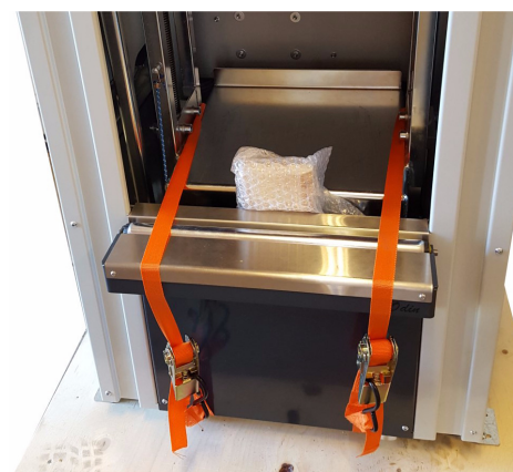
Рис. 5-14: Внутри машины имеется две стяжки и деревянный брус. Их нужно удалить перед началом работы.
