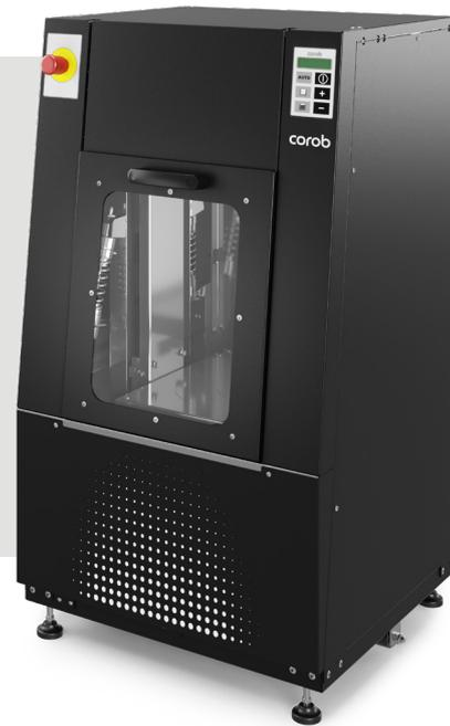
Der EVOshake 700 ist der neueste automatische Rüttler von COROB im High-End-Bereich. Er ist die ideale Lösung für die Farbproduktion mit mittlerem bis hohem Volumen, da er höchste Leistung und Zuverlässigkeit mit Platzersparnis durch seine sehr kompakte Form und vertikale Schiebetür verbindet.
