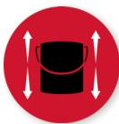
震荡混匀技术依靠作用于涂料桶的垂直作用力，是在基础漆中混匀色浆的传统常用方式之一。该技术通过高强度的上下往复作用力作用于涂料桶，最终能实现优异的混匀效果。
