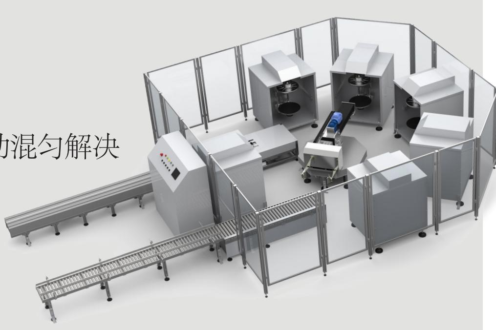
COROB混匀工作站是处理各种形状、尺寸的塑料或金属包装罐中的高粘度产品的理想解决方案，同时满足仓库和工厂生产设施的需求。
