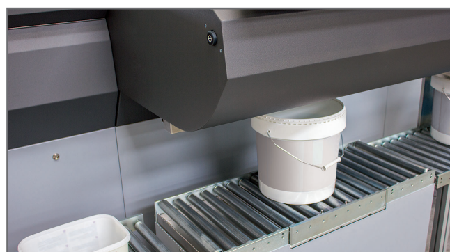
符合人体工程学的可调节自动滚筒输送带。
