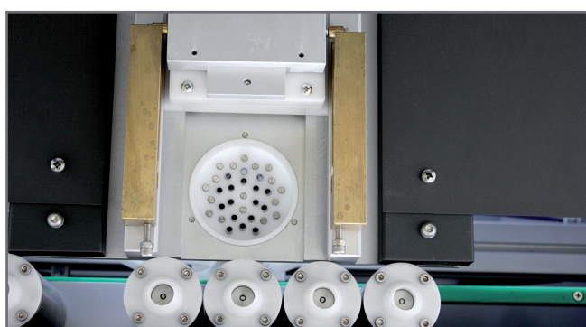
色浆的喷嘴中心和基漆的可移动式灌装阀门。
