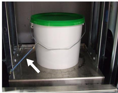
Figura 6-20: Confezione con manico correttamente fissato per l'agitazione.
