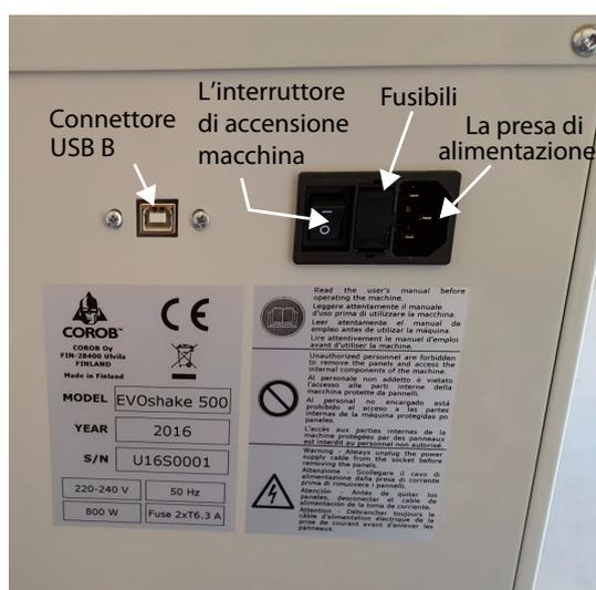
Figura 6-17: Il cavo di alimentazione deve essere collegato sul retro della macchina.
