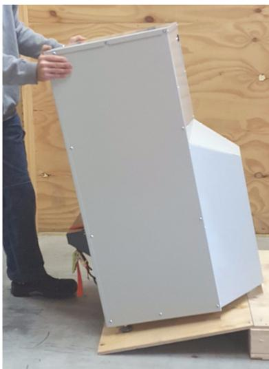
Figura 5-12: Se necessario, inclinare leggermente la macchina per facilitare la discesa dalla rampa.
