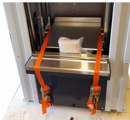
*Figura 5-14: All'interno dell'agitatore sono presenti due fascette di blocco e un travetto di legno che fissano le parti mobili. Rimuovere questi sistemi di fissaggio prima di azionare l'agitatore.*
