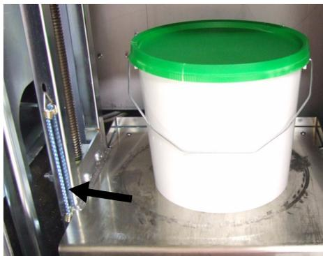
Figura 6-19: Il manico della confezione viene fissato al telaio dell'agitatore.
