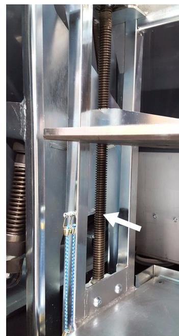
Figura 7-23: Vite che consentono l'apertura dei piatti di serraggio.
