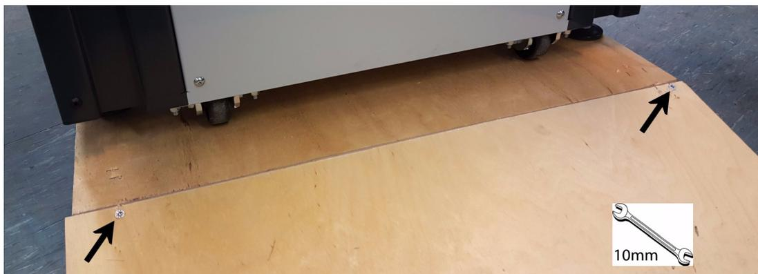
Figura 5-7: Fissare il coperchio dell'imballo al pallet con due viti.
