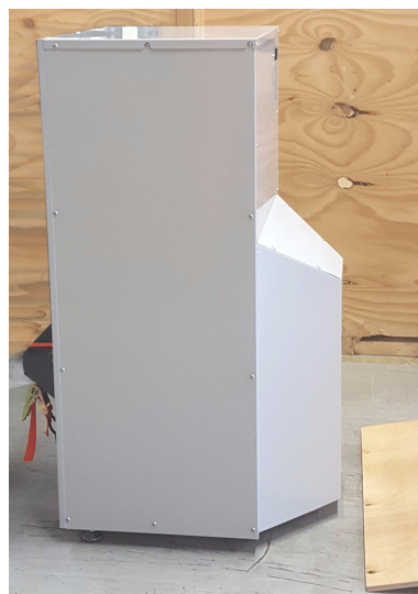
Bild 5-13: Dra COROB™ EVOshake 500 sakta till underlaget.
