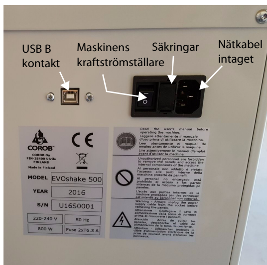
Bild 6-17: Kraftförsörjningskabeln är ansluten på maskinens baksida.
