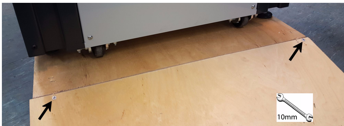
Bild 5-7: Fäst locket på pallen med två skruvar.
