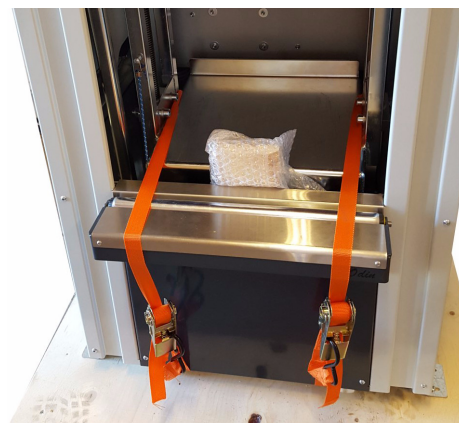
Bild 5-14: Två spärremmar och ett block är placerade på maskinens insida. Dessa måste avlägsnas före blandning.
