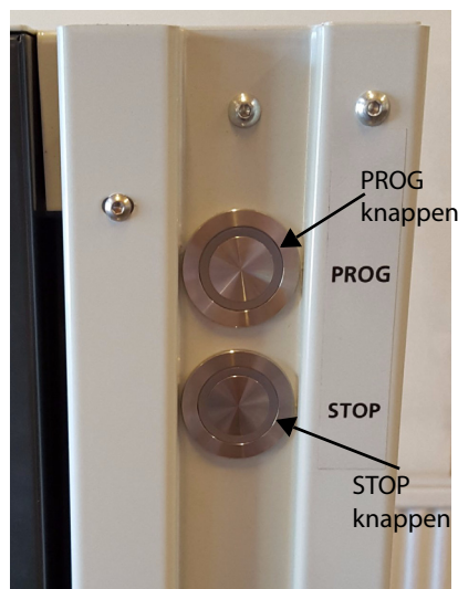
Bild 6-18: Manöverorganen är placerade på COROB™ EVOshake 500 framsida.
