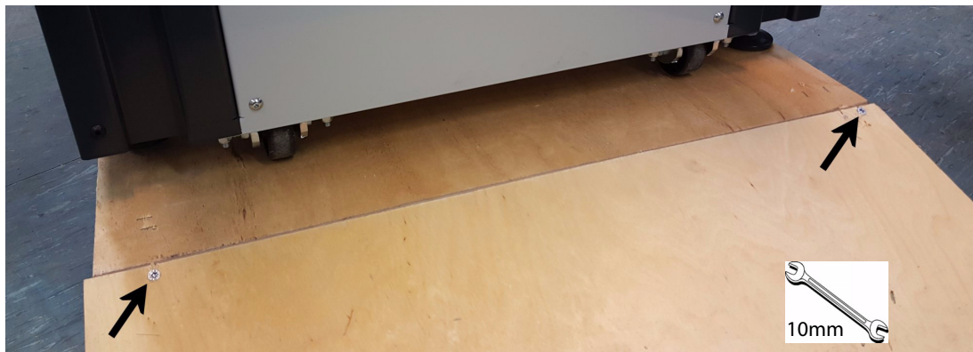
Rysunek 5-7: Zamocuj pokrywę dwiema śrubami do palety.
