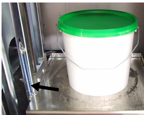
Rysunek 6-20: Uchwyt maszyny jest przymocowany do korpusu mieszalnika.
