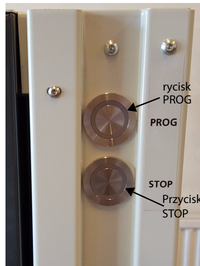
Rysunek 6-19: Urządzenia sterujące znajdują się na przodzie maszyny COROB™ EVOshake 500.
