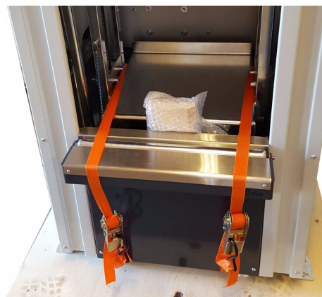
Rysunek 5-15: Wewnątrz maszyny są dwa pasy transportowe i jeden klocek. Należy je wyjąć przed mieszaniem.
