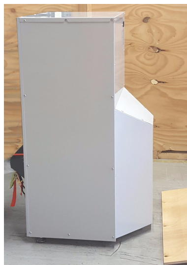
Rysunek 5-13: Zsuń powoli maszynę COROB™ EVOshake 500 na posadzkę.
