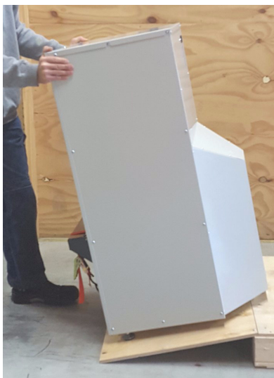
Rysunek 5-12: Odchyl nieco mieszalnik, aby ułatwić ruch po rampie.
