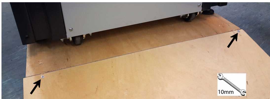
Figuur 5-7: Maak de deksel met twee schroeven aan de pallet vast.
