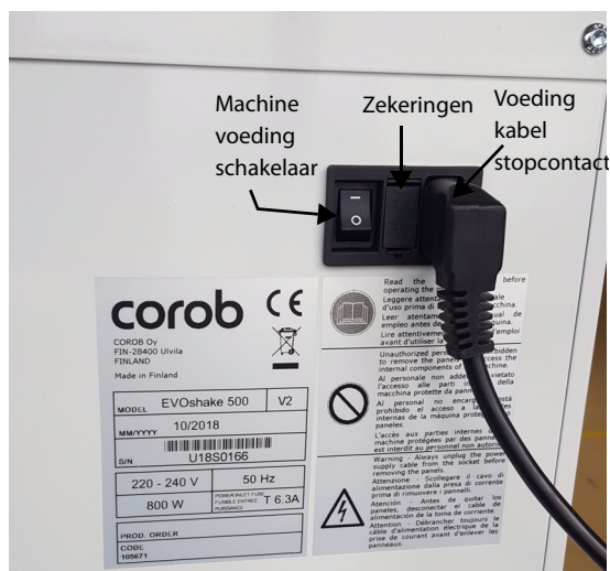
Figuur 6-18: De voedingskabel is aangesloten op de achterzijde van de machine.
