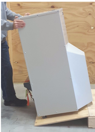
Figuur 5-12: Kantel de verschuider een beetje om hem gemakkelijker over de helling te verplaatsen.
