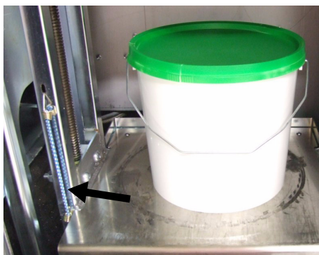
Figuur 6-20: De handvathouder is aan de romp van de verfschudder vastgemaakt.
