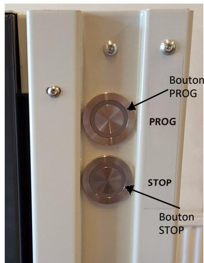
Figure 7-19: Les commandes se trouvent à l'avant de l'EVOshake 500.
