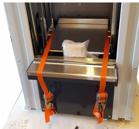
Figure 6-15: Il y a deux sangles à cliquet et un bloc à l'intérieur de la machine. Ceux-ci doivent être enlevés avant l'agitation.
