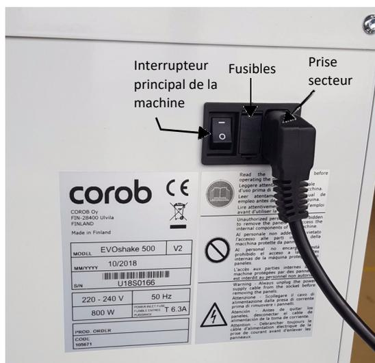
Figure 7-18: Le câble d'alimentation est branché à l'arrière de la machine.
