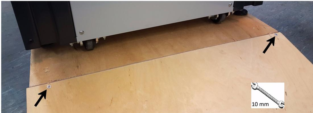
Figure 6-7: Fixez le couvercle à la palette au moyen de deux vis.
