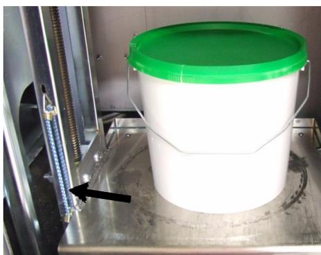
Figure 7-20: Le dispositif de fixation de la poignée est attaché au corps de l'agitateur.
