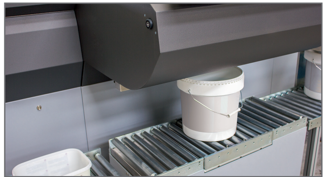
Cinta transportadora de rodillos automatizada y ajustable para garantizar un flujo de envases ergonómico y fácil de usar.
